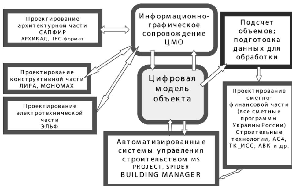
*Рис. 1. Схема организации технологии проектирования строительного объекта*
